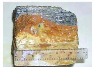
Fig. 2: Ladrillo de sílice reparado por el método de soldadura cerámica
