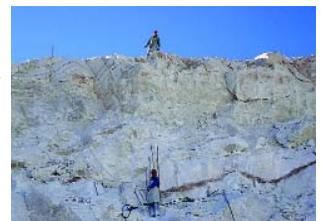
Frente de cantera con operarios efectuando perforaciones para voladuras.
